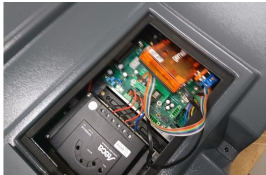
Abbildung 15: Einlegen des Modems in den Kasten des I-SAFE
