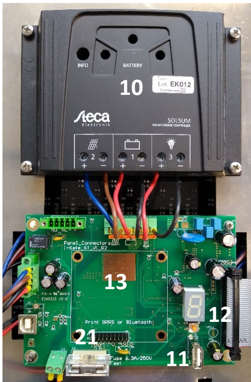
Abbildung 5: Solarregler und Inneres des Steuerungskastens
