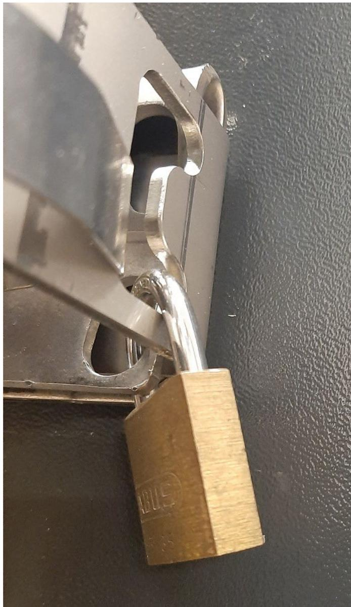
*Figure 17 : fixer le cadenas au support*
