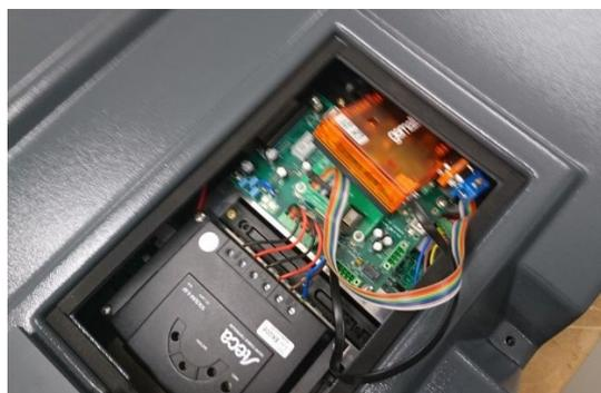
Figure 15 : insertion du modem dans le caisson I-SAFE
