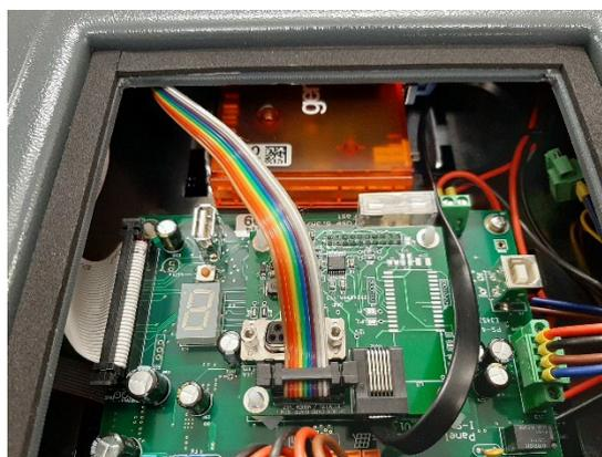
Figure 16 : modem inséré dans le caisson I-SAFE
