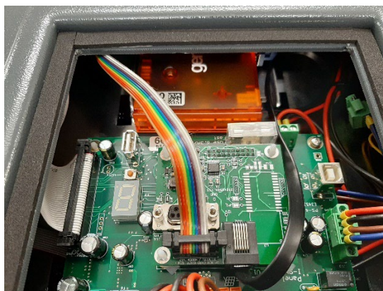
Figuur 15: modem in de I-SAFE behuizing geslepen
