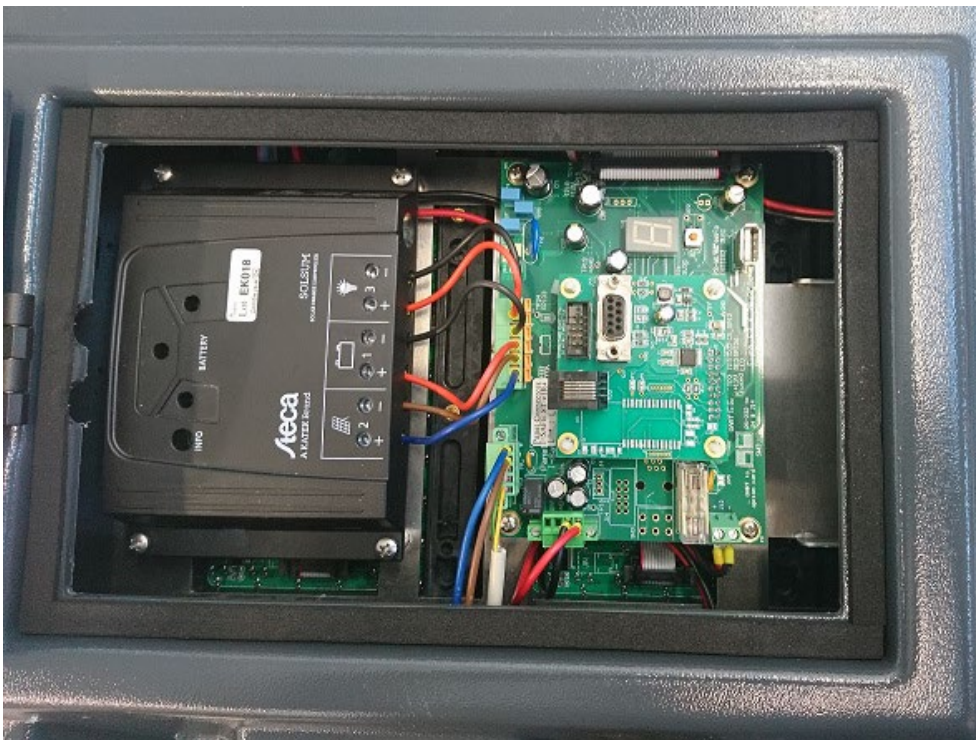
Figuur 13: open de achterklep van de I-SAFE
