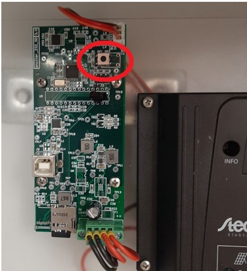
Figure 16 : bouton poussoir pour arrêter l'enregistrement sur la carte SD
