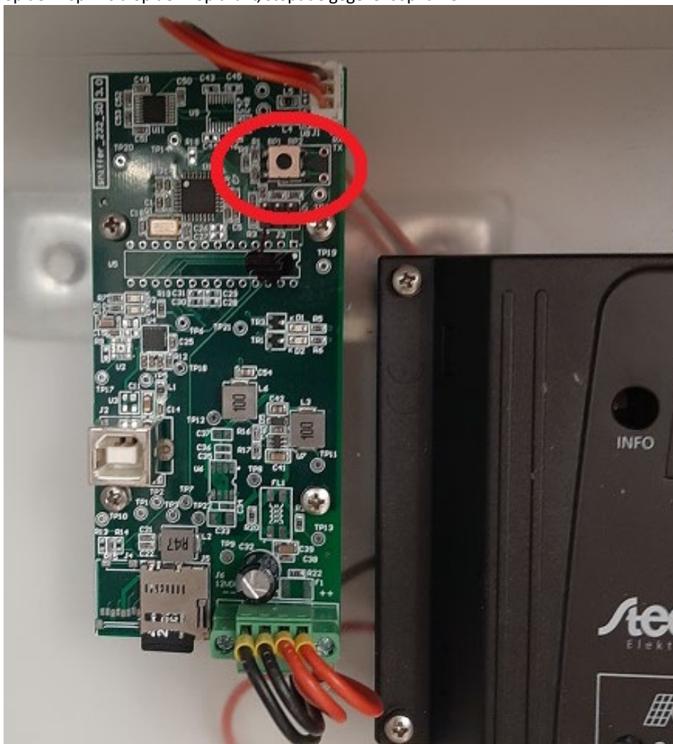
Figuur 16: drukknop om de opname op de SD-kaart te stoppen
