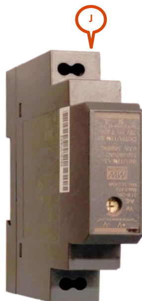
Figuur 23: optionele transformator voor de relais-kaart
