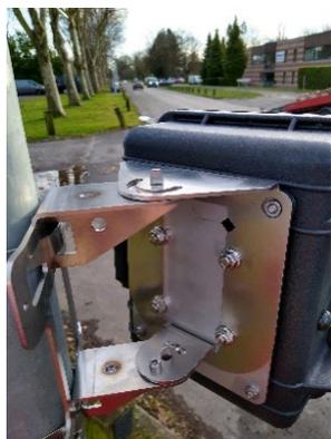
Figura 20: vite di orientamento, -45°
