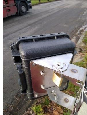
Figura 17: orientamento a 45° con vite di fissaggio e lucchetto opzionale
