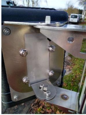
Figura 16: vite di fissaggio
