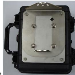
Sostituire la parte conica con la staffa in acciaio come illustrato
