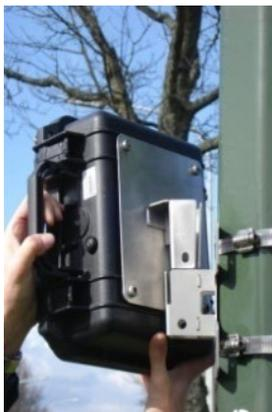
*Figura 8: staffa di fissaggio + fascette di fissaggio*
