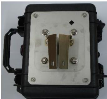
Figura 3: staffa conica orientata di 45 gradi
