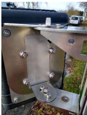
Figura 16: vite di fissaggio
