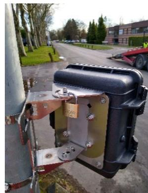
Figura 21: orientamento a-45° con vite di fissaggio e lucchetto opzionale
