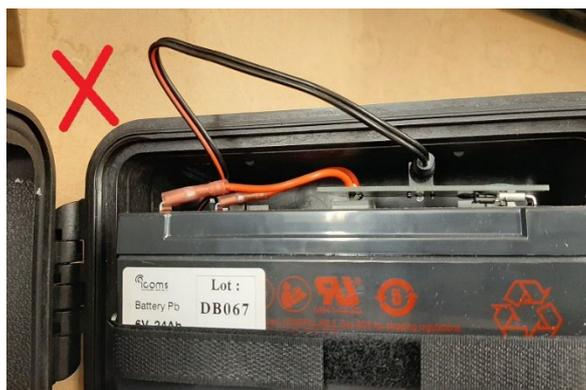
Figura 30: filo da fissare sopra la batteria
