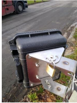
Abbildung 17: Ausrichtung im 45°-Winkel mit Klemmschraube und Vorhängeschloss (optional)
