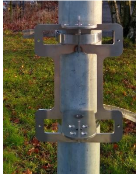
Abbildung 11: Halterung und Schellen in der Frontansicht
