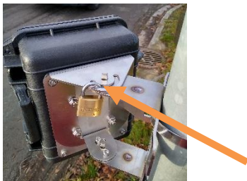
Abbildung 23: Bereich zur Anbringung eines Vorhängeschlosses zur Diebstahlsicherung
