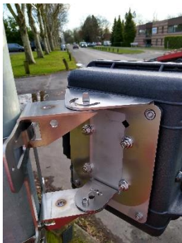
Abbildung 20: Stellschraube im -45°-Winkel
