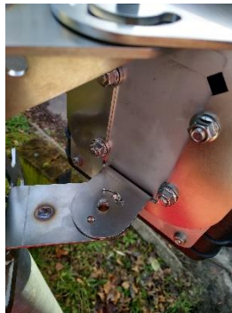
Abbildung 19: Markierung für -45°-Winkel
