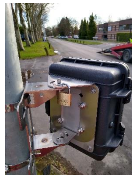
Figure 21 : vis de serrage à -45° et cadenas
