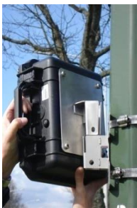
Figuur 8: drager + achterzijde radar
