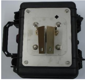
Figuur 3: standaard 45° montagestuk
