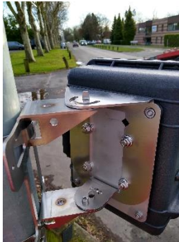
Figuur 20: oriëntatieschroef voor -45°
