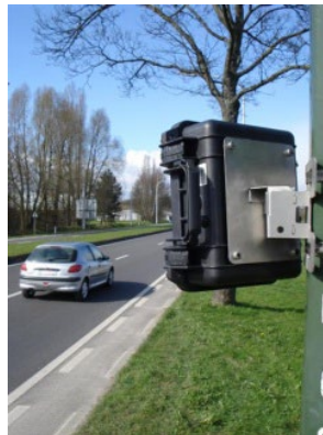
Figure 9 : arrière du radar posé
