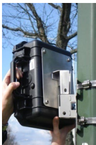
Figuur 8: drager + achterzijde radar
