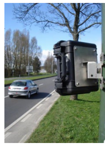
Figuur 9: achterzijde van de geplaatste radar
